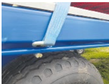
Surringsrör under kantlinan längs hela flaket
